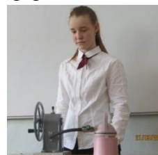
Рис.4. Опыт 3 (фото автора) Если тянуть с двух сторон, то нельзя разделить полусферы. Какая же сила удерживает полусферы?
